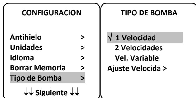
**⚠ No intentar cambiar el "TIPO BOMBA" por una versión no adaptada si una bomba ya está conectada al relé de filtración. Podría dañar la bomba y el relé al mismo tiempo.**
