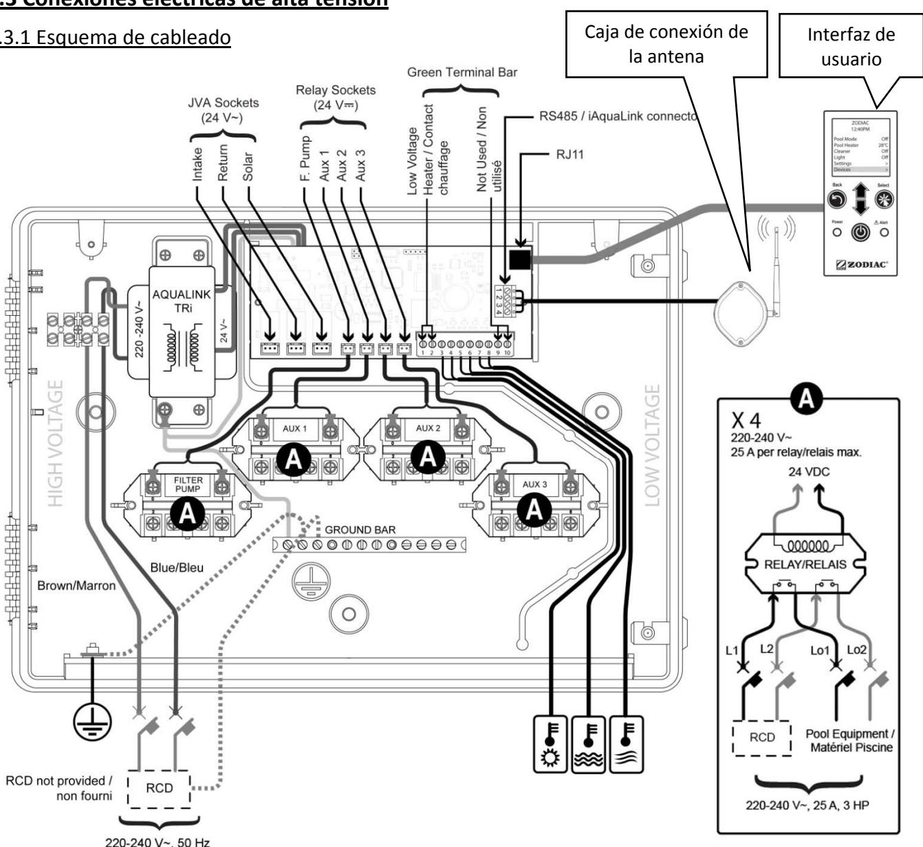
**"RCD"** (= Residual Current Device): dispositivo de protección diferencial.
