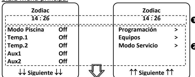
① La segunda línea de la pantalla muestra alternativamente la hora, la temperatura del aire, la temperatura del agua (si la filtración está en funcionamiento), la temperatura solar (si la función está activada) y los eventuales mensajes de alerta.
