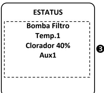
③ La pantalla de inicio se alterna con la pantalla "ESTATUS" si uno o varios equipamientos de la piscina están en funcionamiento. Esta pantalla detalla la lista de equipamientos que están en funcionamiento actualmente.
