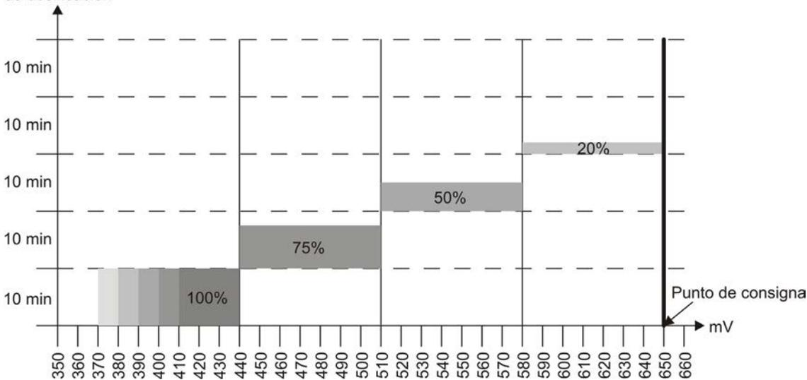
**i** Esta inyección proporcional es cíclica y la duración de cada ciclo es de 10 minutos. Lo que cambia la dosis es la distribución de los tiempos de inyección y de pausa. La proporcionalidad se ajusta automáticamente y el reparto entre las distintas dosificaciones se realiza por etapas de 70 mV.
